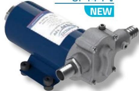
**IT** Elettropompe autoadescenti con ingranaggi elicoidali in PTFE e valvola di non ritorno incorporata. Corpo e raccordi in ottone nichelato, albero in acciaio inox. Applicazione principale: sentina.
