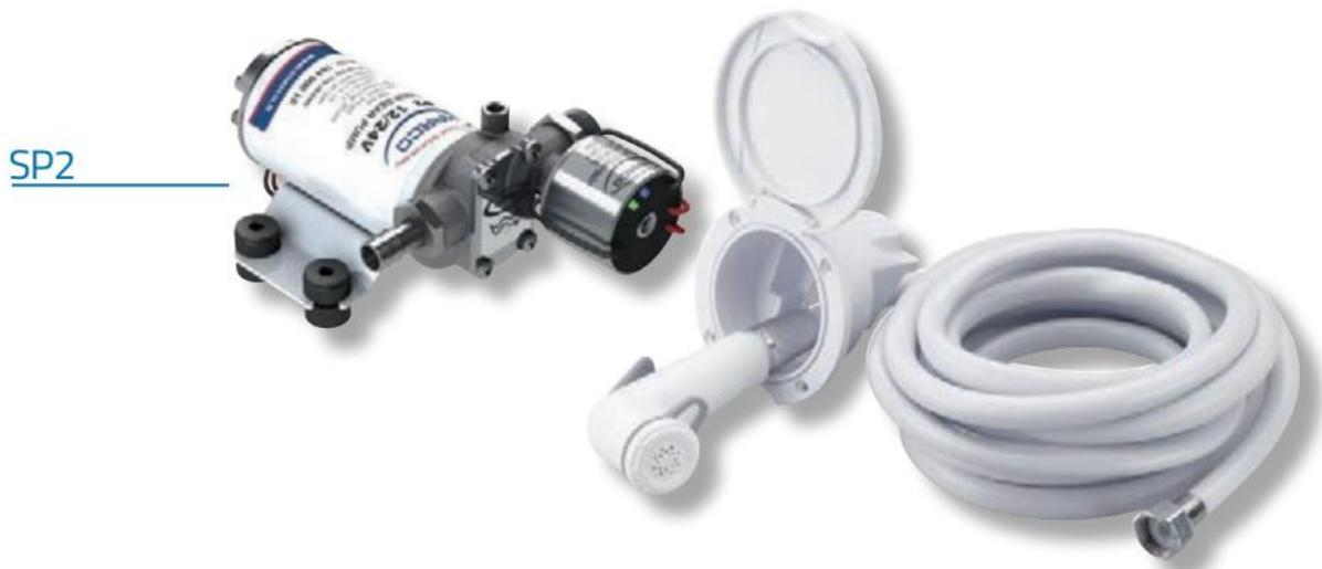
**IT** Kit doccia completo di elettropompa con controllo elettronico. Compatta e auto-adescante, la pompa è dotata di ingranaggi elicoidali in PTFE, corpo e raccordi in ottone nichelato e valvola di non ritorno integrata nel corpo. Completo di 4m di tubo bianco con raccordi a vite, erogatore, scatola da incasso. Particolarmente adatto per installazioni su yachts, gommoni, barche a vela.
