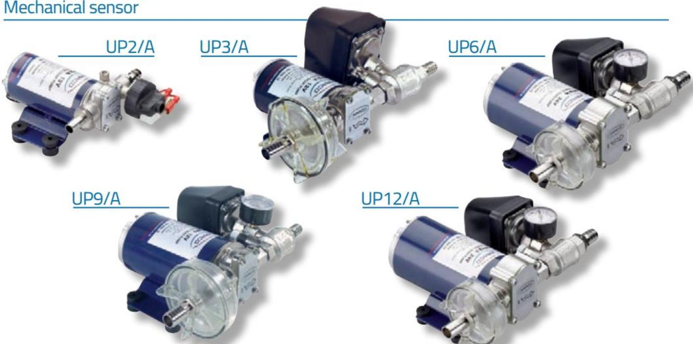
**IT** Elettropompe autoadescanti ad ingranaggi elicoidali in PTFE, corredate di filtro in linea, valvola di non ritorno e pressostato, per impiego come pompe automatiche per sistemi acqua potabile su imbarcazioni, camper, ecc. Corpo in ottone nichelato, alberino in acciaio inox.
