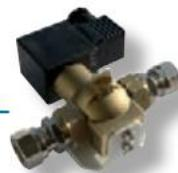
**IT** Elettrovalvole di intercettazione carburante per imbarcazioni entrobordo, conformi alle prescrizioni RINA. Corredate di uno speciale dispositivo per lo sblocco manuale della valvola che garantisce il passaggio del carburante anche in caso di guasto all'impianto elettrico. Complete di raccordi a bicono per tubi di vario diametro. Corpo in ottone e staffa in acciaio verniciato.
