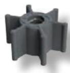
**IT** Girante in speciale gomma nitrilica. Ricambio originale per UP1/J. Dimensioni 22 x Ø 40,5 mm - foro Ø 8 mm.
