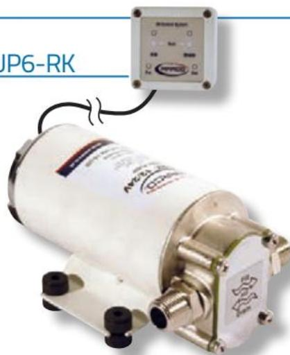
**IT** Pompe con controllo elettronico per operazioni di travaso e rifornimento olio e gasolio. Il controllo elettronico regola la velocità del motore in base alla viscosità e alla temperatura del liquido. Le dimensioni ridotte consentono il montaggio in qualsiasi vano motore. Il sistema va in blocco automatico in caso di fine liquido, cortocircuito e dopo 30 min. di operatività. Disponibili raccordi con 1 o 2 valvole.
